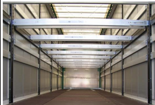
Aménagement à deux niveaux pour plus d'emplacements
